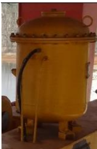
Figure 15 : Vue du réservoir d'huile du palonnier hydraulique
